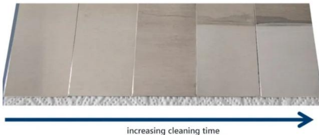
图 2: 从左向右清洁后钢板的照片，清洁时间逐步延长
