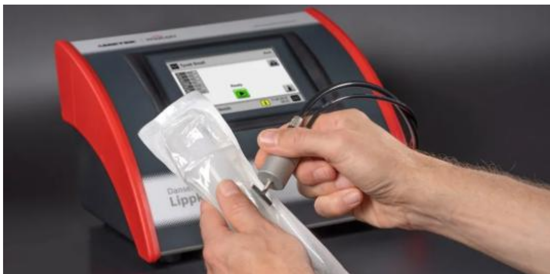
Lippke 5000 泄露测试仪用于测试包装完整性和密封泄露性
