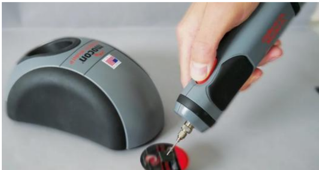
OpTech-O2 Model P 用于测试 K-cup 胶囊咖啡的顶空气体，作为保质期研究的一部分。
